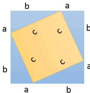
В итоге получим квадрат со стороной  $c$  и четыре прямоугольных треугольника с катетами  $a$  и  $b$  и гипотенузой  $c$ , внутри квадрата со стороной  $a + b$ . **Площадь прямоугольного треугольника с катетами  $a$  и  $b$  равна  $ab/2$ . Площадь квадрата со стороной  $a + b$  равна  $(a + b)^2$ . Площадь маленького квадрата равна  $c^2$ .** Следовательно, можно написать равенство  $(a + b)^2 = 4(ab/2) + c^2$ .
