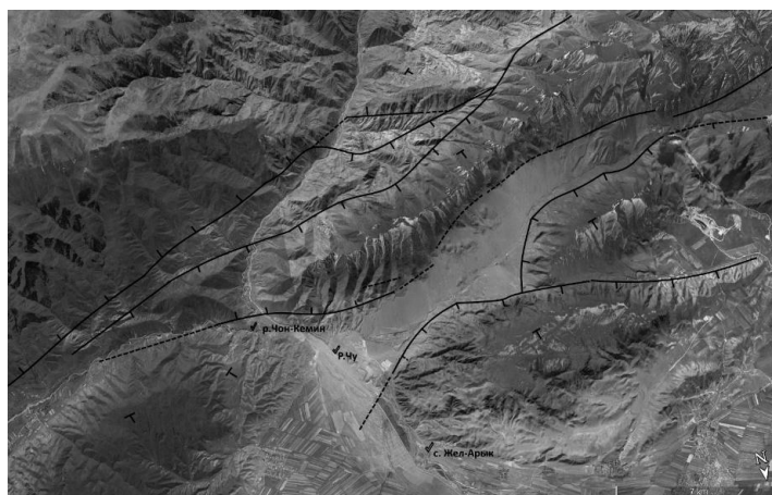
Рис. 3. Сейсмотектоническая ситуация эпицентральной зоны Кемино-Чуйского землетрясения 1938 г. Черными линиями показаны основные новейшие разломы. Бергштрихи в сторону падения сместителей разломов. Штриховые линии – предполагаемое положение разломов.
